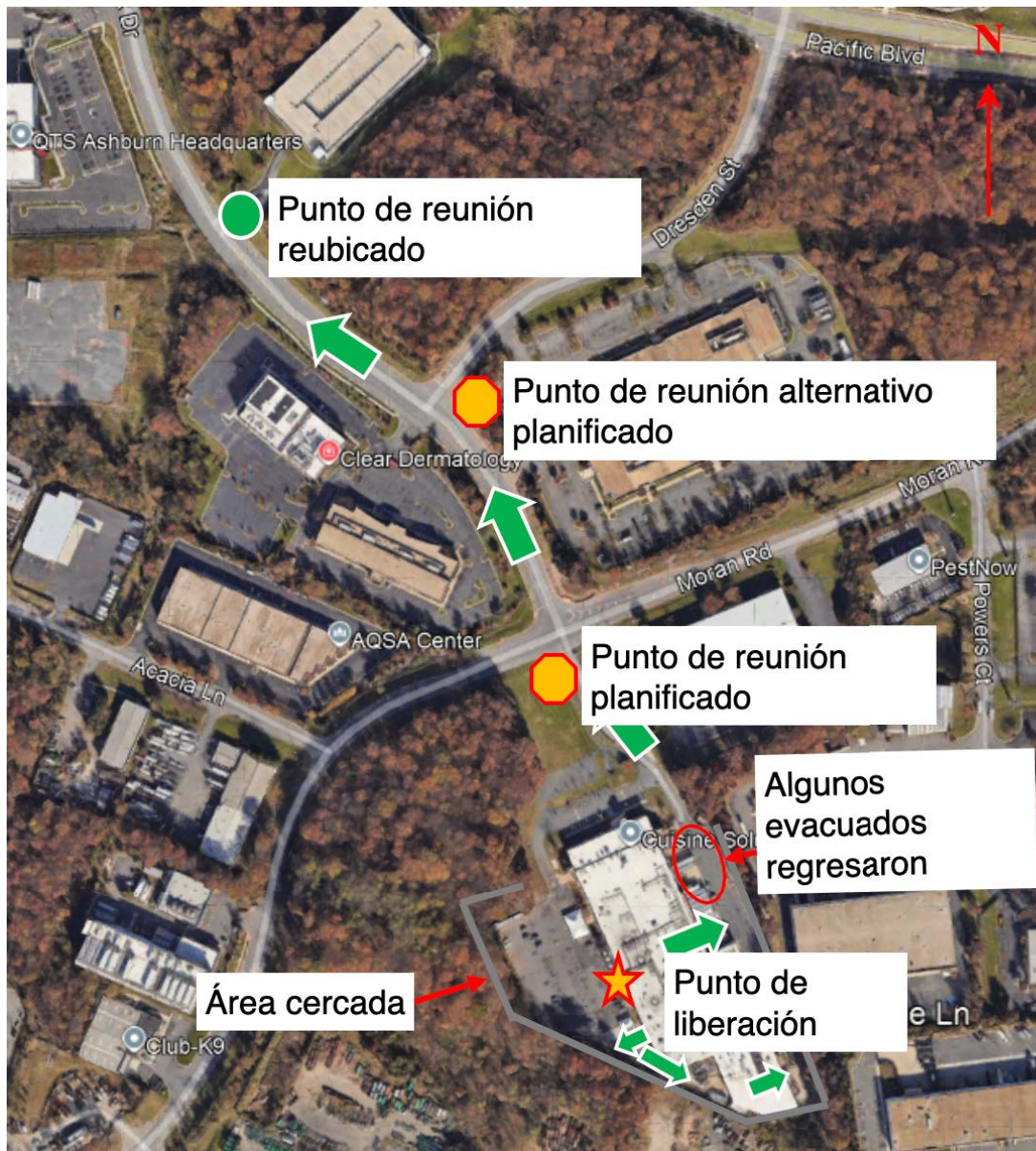
Figura 31: Los evacuados se alejaron más del lugar de lo indicado en el PAE debido al olor a amoníaco. (Crédito: Google Earth, anotado por CSB)
