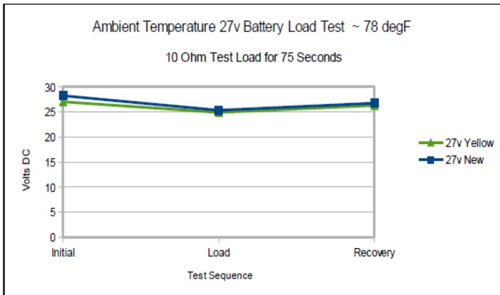
**Figure A3-4: 27 volt Ambient Load Test Results**
