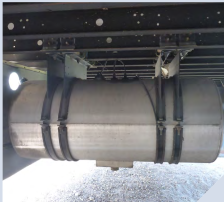
Imagen anterior: Remolque refrigerado. Imagen superior derecha: Mecanismo de refrigeración al frente del remolque. Primera foto: Tanques de combustible Diesel para el remolque refrigerado, ubicado en la parte inferior del mismo.
